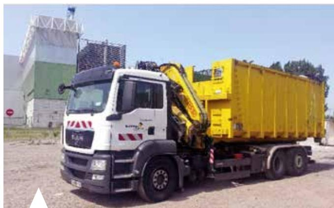
Camion-grue avec benne (collecte des PAV)
